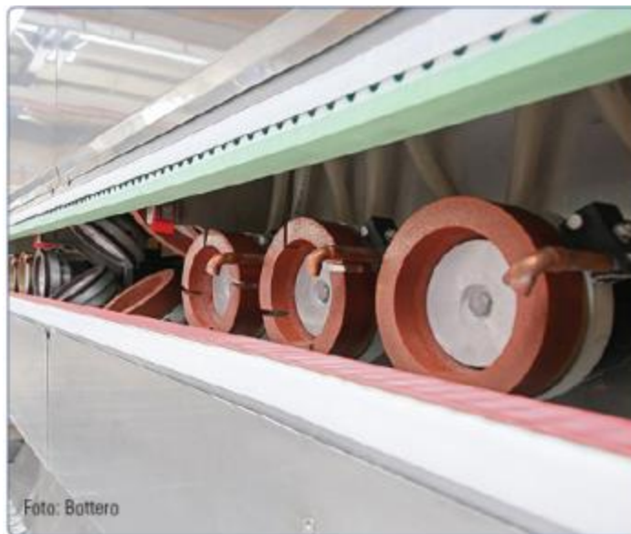
I drive di KOLLMORGEN permettono l'azionamento delle mole e il posizionamento preciso delle lastre.
